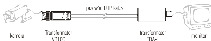
Rys.2 Zasięg przy zastosowaniu transformatora pasywnego VB10C oraz aktywnego TRA-1: 2200m - cz/b, 2700m - kolor.
