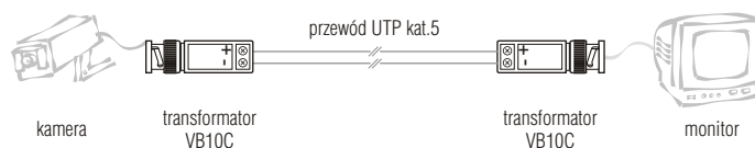
Rys.1 Zasięg przy zastosowaniu dwóch transformatorów pasywnych VB10C: 600m - cz/b, 400m - kolor.
